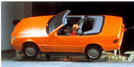
Der SL beim Überschlag-Test. Noch tritt der Überrollbügel nicht in Erscheinung. Aber Schalter an den Federlenkern der Hinterachse
