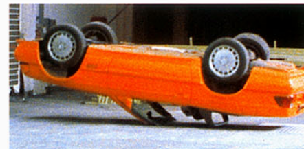
Der „Augenblick der Wahrheit“ - der Bügel stützt das Fahrzeug zusammen mit dem Scheibenrahmen wirkungsvoll ab. Je nach der Wucht
