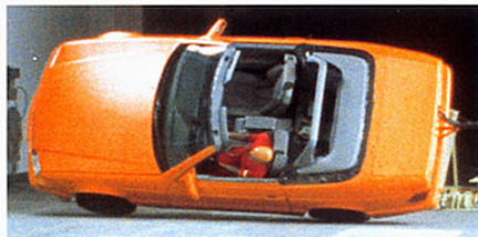
Nur Sekundenbruchteile später: Der im Auslösegerät integrierte Neigungsschalter hat der Elektronik signalisiert, daß das Fahr-
