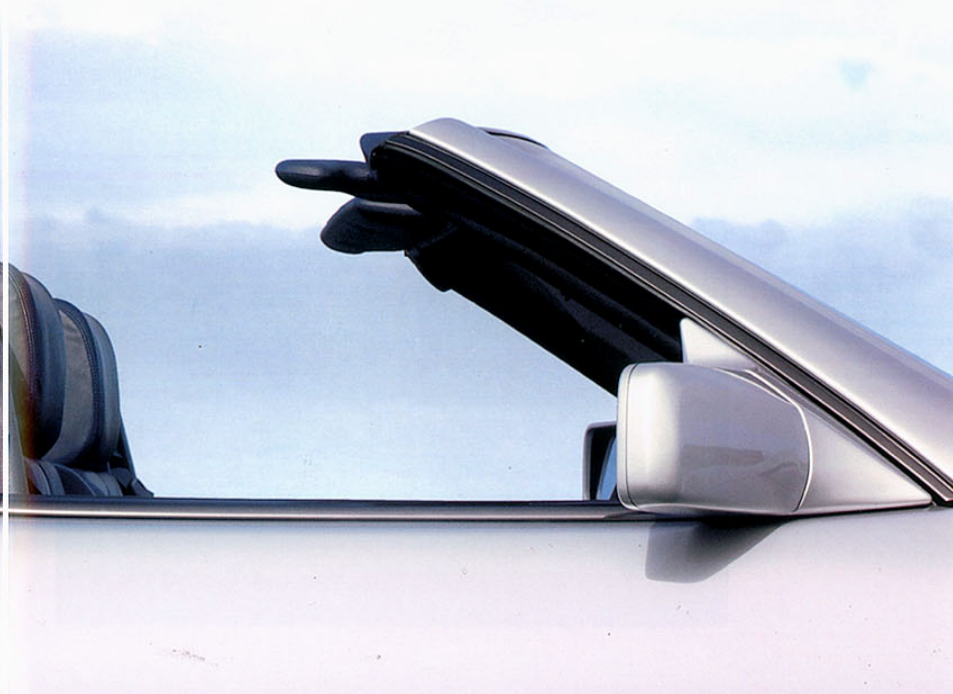
Der „Augenblick der Wahrheit“ - der Bügel stützt das Fahrzeug zusammen mit dem Scheibenrahmen wirkungsvoll ab. Je nach der Wucht
