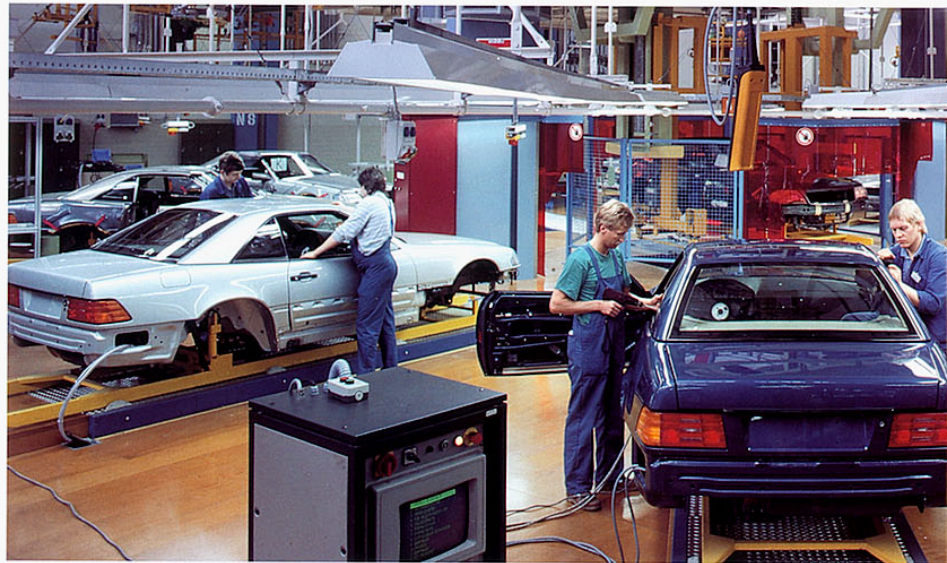
Modernste Technologien werden für den Langzeitschutz des SL eingesetzt. Die mit Hilfe feinfühleriger Elektronik aufgenommene Hohlraumkonservierung schützt so zuverlässig und dauerhaft, daß eine Nachbehandlung während der gesamten Betriebszeit des Fahrzeuges nicht erforderlich ist.
