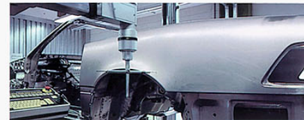
Ein aufwendiges Qualitätssicherungssystem begleitet den SL durch alle Fertigungsbereiche. So werden zum Beispiel alle wesentlichen Karosseriemäße ständig auf Einhaltung der extrem engen
