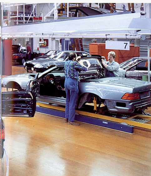
Boxenfertigung des SL: Kreisförmig sind die Stellplätze in den Montagesternen um den Drehteller angeordnet. Mittels Drehteller und Heber werden die Fahrzeuge auf die Montageebene abgesenkt. Der Teller dreht bis zu einem freien Stellplatz. Automatisch rollt die Karosserie in die Box, in der Zweier- und Dreier-Teams die Montage-
