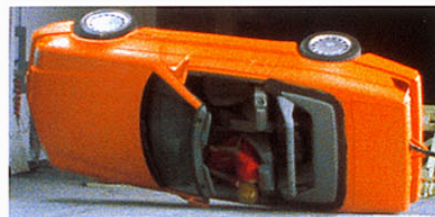
Nur 0,3 Sekunden nach dem Auslösungssignal ist der Bügel voll belastbar. Seine Schutzstellung ist
