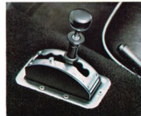
Der Schalthebel für das automatische Getriebe liegt auf dem Getriebetunnel sehr gut zur Hand
