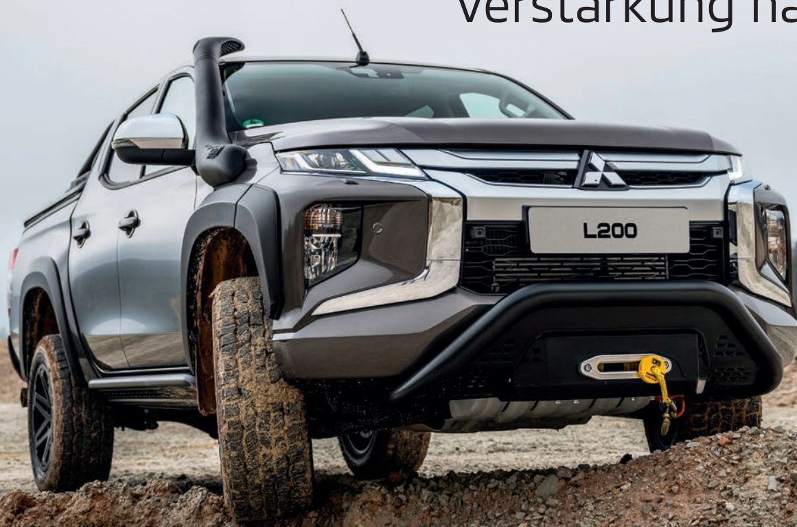
Selbstbergewinde, Frontbügel mit Unterfahrschutz, Kotflügelverbreiterung und Snorkel
