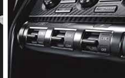
Getriebeeinstellungen: R-Modus, Normal und Save
