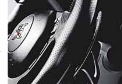
Leichtbau-Schaltwippen aus Magnesium am Lenkrad
