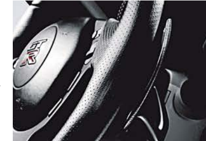
Leichtbau-Schaltwippen aus Magnesium am Lenkrad
