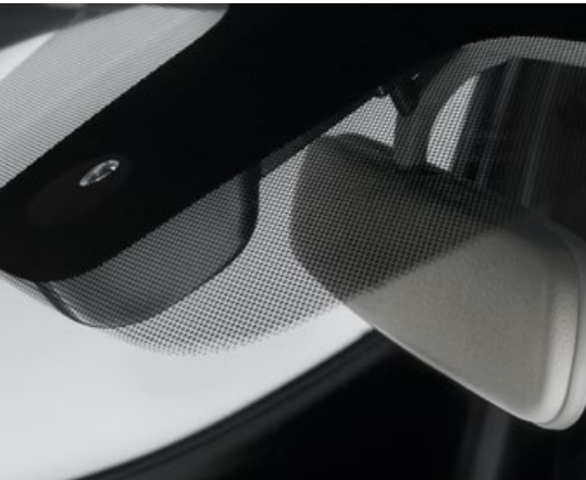
Regensensor und Fahrlichtautomatik
