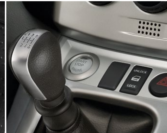
Motor-Startknopf (nur in Verbindung mit INTELLIGENT KEY)
