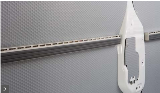
2. Fest an den Seitenwänden rechts und links sind die ProSafe Ladungssicherungsschienen montiert. Dort können die Zurrgurte aus dem Ladungssicherungskoffer leicht befestigt werden. So bleibt die Ladung an ihrem Platz.
