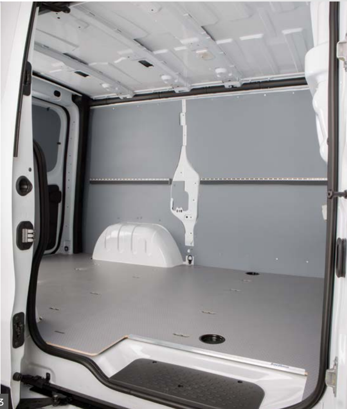
3. Hier einmal der komplette Ausbau auf einen Blick: - SoboGrip Boden - ProSafe Zurrpunkte im Boden integriert - SowaFlex Wandverkleidung an der Hecktür - ProSafe Ladungssicherungsschiene an der Seitenwand 4. Der SoboGrip Holzboden ist 9 mm stark, 7-fach wasserfest verleimt, kratzbeständig und rutschfest beschichtet. Weiter sind ProSafe Zurrpunkte in dem Boden zum praktischen Niederzurren befestigt.
