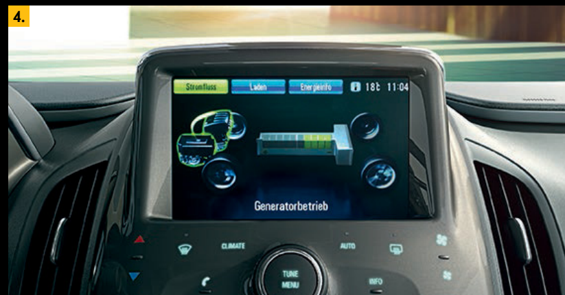
3. Die Energieflussanzeige wird über das Feld links oben im Display aufgerufen. Sie zeigt Ihnen, in welcher Betriebsart Sie unterwegs sind und welche Reichweite mit der jeweiligen Energiequelle zur Verfügung steht. Fahren Sie ausschließlich mit gespeicherter Elektrizität, leuchtet das Batteriesymbol grün. 4. Wenn der bordeigene Stromgenerator anspricht, wird dagegen das Motorsymbol optisch hervorgehoben und der Stromfluss entsprechend angezeigt.
