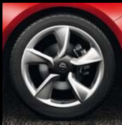
Leichtmetallrad 8 J x 19 im 5-Speichen-Design, Reifen 235/45 R 19 (RT8). Optional für Edition und INNOVATION.
