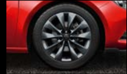
Leichtmetallrad im „Active“-Design, 7½ J x 18 mit Reifen 235/50 R 18. (SGE) Serie bei Active
