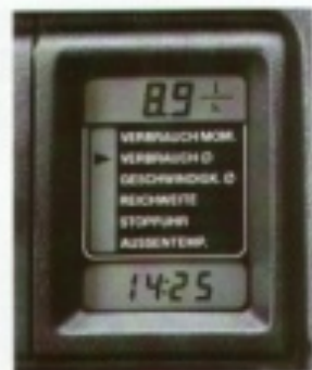
Ein Bordcomputer liefert ständig aktuelle Infos über den durchschnittlichen und den augenblicklichen Kraftstoffverbrauch, die Durchschnittsgeschwindigkeit,
