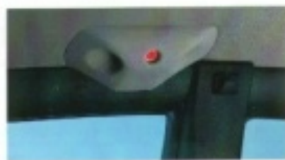
Diebstahlschutzanlage mit Ultraschallsensoren.
