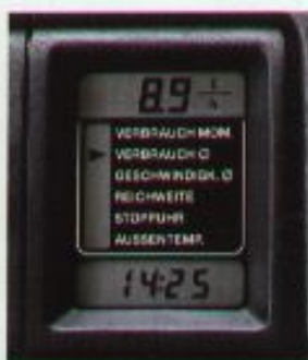
Ein Bordcomputer liefert ständig aktuelle Infos über den durchschnittlichen und den augenblicklichen Kraftstoffverbrauch, die Durchschnittsgeschwindigkeit, die Außentemperatur, die momentane Reichweite und natürlich die Uhrzeit. Darüber hinaus ist eine Stoppuhr integriert (Sonderausstattung).
