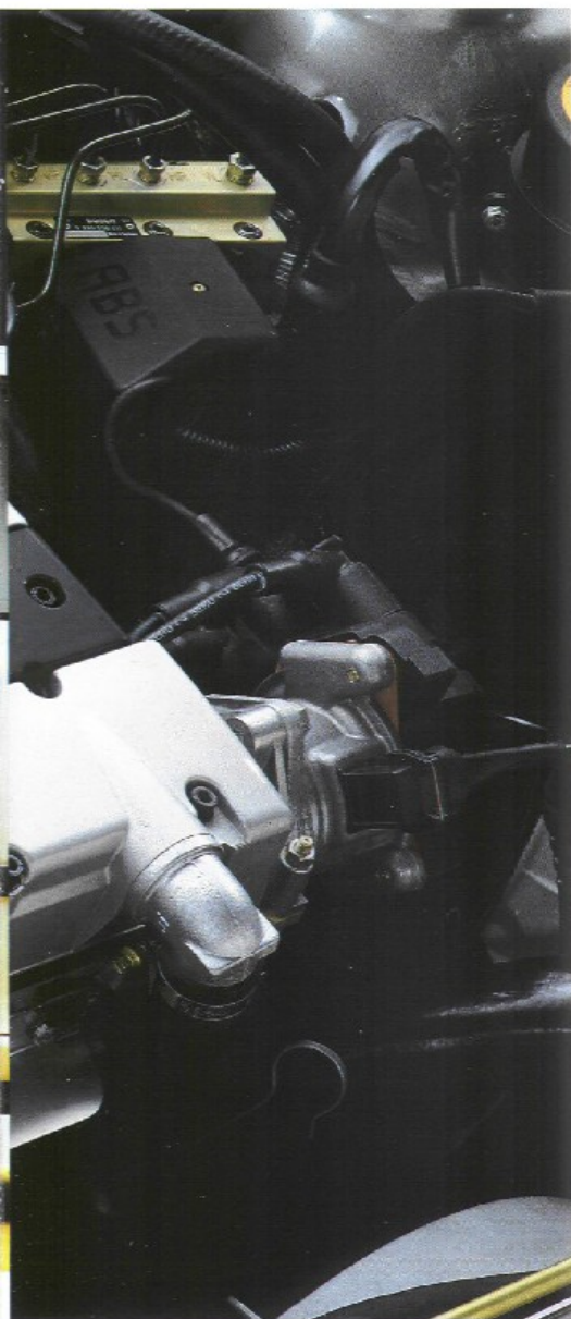
2.0-16V-Turbomotor mit 150 kW (204 PS). In dieser Motorisierungsvariante besitzt der Calibra permanenten Allradantrieb – wie der hochentwickelte DTM-Rennwagen.
