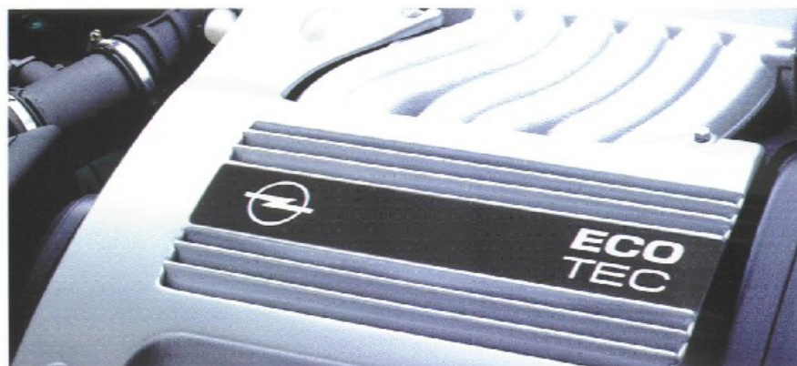
V6 ECOTEC Motor. Das kompakte High-Tech-Triebwerk mit 2.5 Liter Hubraum, 24 Ventilen und 125 kW (170 PS).
