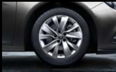
Leichtmetallräder im „5-Doppelspeichen“-Design, 7 1/2 J x 18 mit Reifen 235/50 R 18 (RQH).
