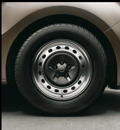
Stahlrad 6 J x 15, Reifen 185/65 R 15. 1
