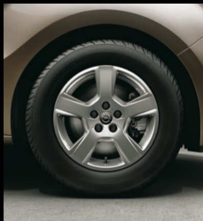
Leichtmetallrad 6 J x 15, Reifen 195/65 R 15. 3
