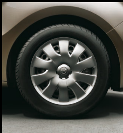
Stahlrad 6 J x 16, Reifen 195/60 R 16. 2
