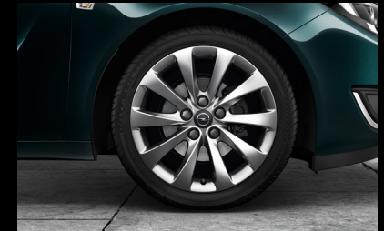
Leichtmetallrad im „10-Speichen“-Design, 8 J x 18 mit Reifen 245/45 R 18 (RED).
