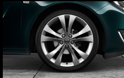
Leichtmetallrad im „5-Doppelspeichen-Stern“-Design, 8½ J x 20 mit Reifen 245/35 R 20 (RTH).
