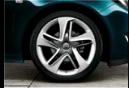
19"-Leichtmetallräder im „5-Sternspeichen“-Design, 8 1/2 J x 19 mit Reifen 245/40 R 19 (WR8). 3 Oder 8 1/2 J x 19 mit Reifen 245/45 R 19 (WR8 & RKQ). 2
