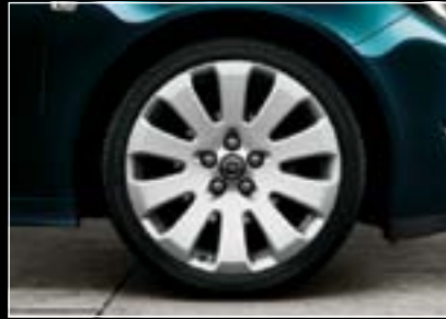
19"-Leichtmetallräder im „10-Speichen“-Design, glanzveredelt, 8 1/2 J x 19 mit Reifen 245/40 R 19 (Q7V). 3
