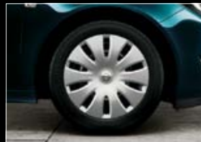
17"-Stahlräder inkl. Radabdeckung im „10-Speichen“-Design, 7 J x 17 mit Reifen 225/55 R 17 (RS9). 5
