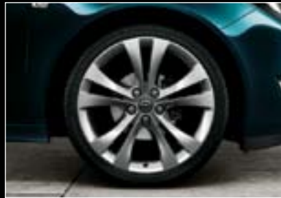
20"-Leichtmetallräder im „5-Doppelspeichen-Stern“-Design, mehrfach beschichtete Premium-Farboberfläche, 8 1/2 J x 20 mit Reifen 245/35 R 20 (RTH). 3
