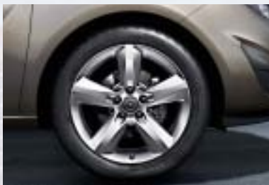
5 Leichtmetallrad 7 J x 17 im 5-Speichen-Design, Reifen 225/45 R 17
