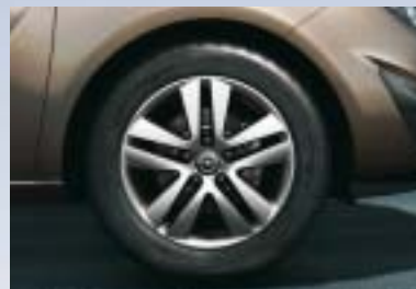
3 Leichtmetallrad 6½ J x 16 im 5-Doppelspeichen-Design, Reifen 205/55 R 16
