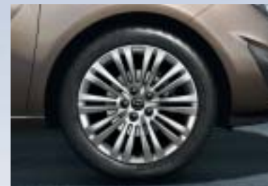
4 Leichtmetallrad 6½ J x 16 und 7 J x 17 im 10-Doppelspeichen-Design, Reifen 205/55 R 16 oder 225/45 R 17
