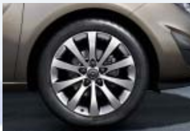
6 Leichtmetallrad 7 J x 17 im 10-Speichen-Design, Reifen 225/45 R 17
