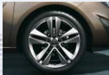
7 Leichtmetallrad 7½ J x 18 im 5-Doppelspeichen-Design, Reifen 225/40 R 18
