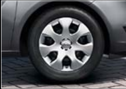
15"- bzw. 16"-Stahlrad inkl. Radabdeckung, 6½ J x 15 mit Reifen 195/65 R 15 (PA7) 2 bzw. 6½ J x 16 mit Reifen 205/55 R 16 (PY3). 3
