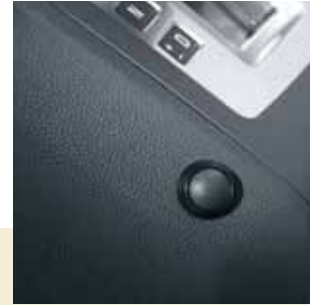
Höchst effektiv – der Auslöseknopf für die Taxi-Alarmanlage.
