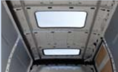
Dachfenster im Laderaum. Ermöglichen eine großzügige Ausleuchtung des Laderaums mit Tageslicht.
