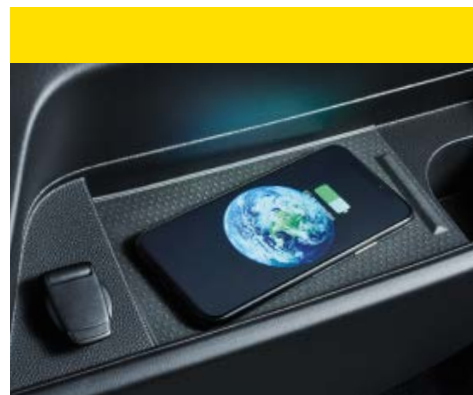
Wireless Charging 1 . Legen Sie Ihr Smartphone einfach in das dafür vorgesehene Fach, um den Akku kabellos aufzuladen.
