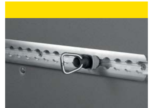
Verschiebbare Verzurrösen 1 . Spezielle für das Opel Movano Schienensystem entwickelte Verzurrösen aus Metall.
