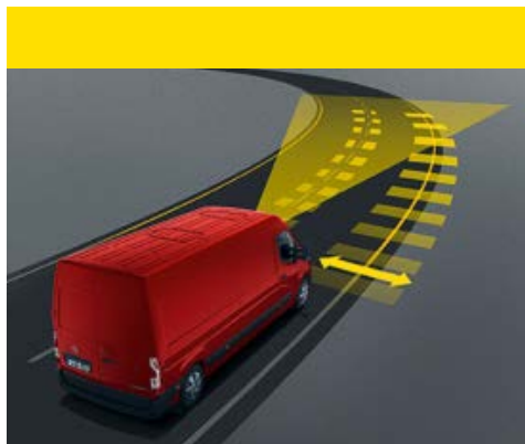
Spurassistent 1 . Warnt bei einem unbeabsichtigten Verlassen der Fahrspur.
