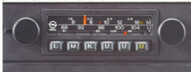
„Le Mans Super“ – UKW, MW, LW, KW; 6 Stationstasten-Senderwahl.
