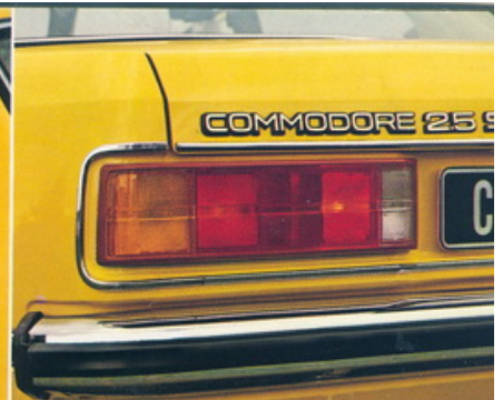
Die Heckleuchten mit integrierten Rückfahrscheinwerfern und der Möglichkeit zum Einbau der Nebelschlußleuchte.
