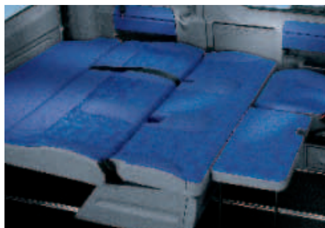
Angenehme Ruhe: Die Sitzbank wird durch einfaches Umklappen zur ebenen Liegefläche. Eine Liegeflächenverlängerung und eine -verbreiterung sind ebenfalls serienmäßig.
