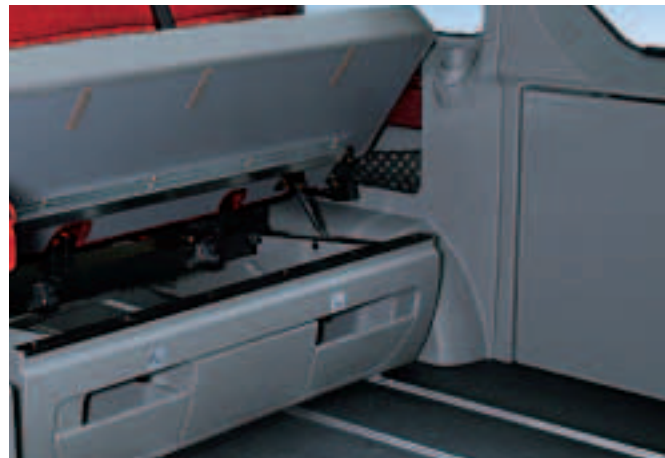
Große Klappe, viel darunter: Die aufklappbare Sitzfläche der Sitzbank bietet reichlich Stauraum und erleichtert das Entriegeln/Verschieben der Sitzbank.
