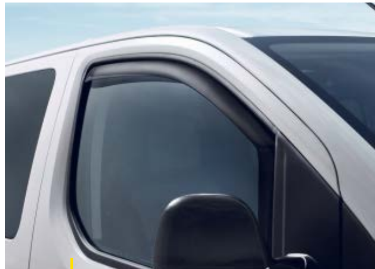
REGEN- UND WINDABWEISER 1 : Versehen Sie die vorderen Türen des Zafira Life mit zwei Windschutzvorrichtungen. Transparent und einfach zum Einklipsen.
