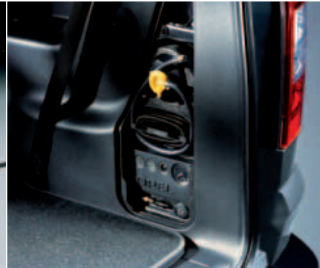
Das Reifenreparaturset ist schnell und einfach anzuwenden und befindet sich in der Seitenverkleidung des Gepäckraums.
