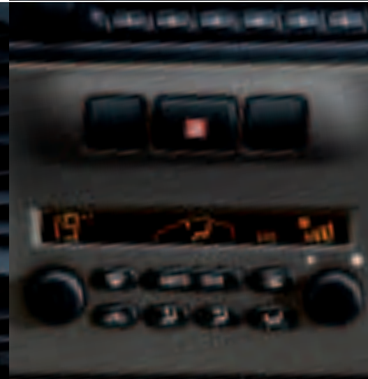
Die elektronische Klimatisierungsautomatik regelt die voreingestellte Temperatur.
