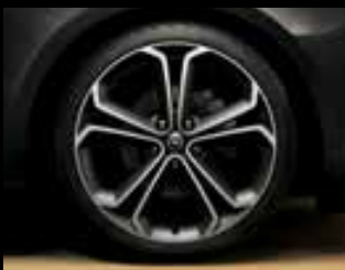
BiColor-Leichtmetallrad 8 J x 19 im 5-Doppelspeichen-Design, Reifen 235/40 R 19 (PZT). Optional für Edition, Sport und INNOVATION.
