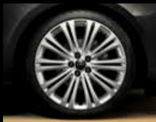
Leichtmetallrad 8 J x 19 im 10-Doppelspeichen-Design, Reifen 235/40 R 19 (RV4). Optional für Edition, Sport und INNOVATION.
