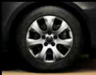
Leichtmetallrad 6 1/2 J x 16 im 7-Speichen-Design, Reifen 215/60 R 16. Zubehörrad 1 .
