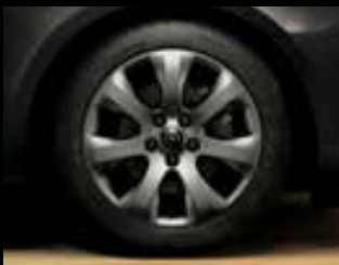
Leichtmetallrad 7 J x 17 im 7-Speichen-Design, titanfarben, Reifen 225/50 R 17. Zubehörrad 1 .
