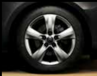
Leichtmetallrad 7 J x 17 im 5-Speichen-Design, Reifen 225/50 R 17 (PWX). Optional für Edition und INNOVATION.
