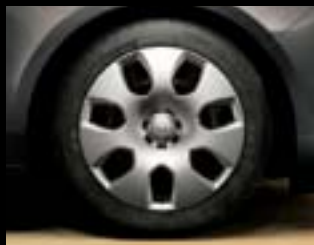
Stahlrad inkl. Abdeckung im „7-Speichen“-Design, 7 J x 17 mit Reifen 225/50 R 17 oder 6½ J x 16 mit Reifen 215/60 R 16 (PWP/PWM).
