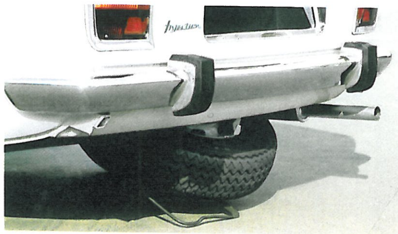
Das Ersatzrad liegt ausserhalb des Kofferraumes, der voll aus- genutzt werden kann.
