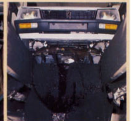
10. UNTERBODENSCHUTZ: Die auf den gesamten Unterboden des Fahrzeugs aufgebraachte Schicht aus Hartwachs und Bitumen vermeidet das Eindringen von Wasser und Feuchtigkeit in die Karosseriehöhlräume.
