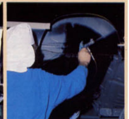
5. STEINSCHLAGSCHUTZ (PVC): Mit ca. 140 0 eingebrannte PVC-Schicht schützt Karosserieteile, die Steinschlag ausgesetzt sind (vor allem am Unterboden und in den Radkästen).
