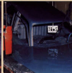
3. KATAPHORESE-TAUCHBAD: Die Karosserie wird elektrolytisch mit einem Epoxidfilm überzogen. Diese Flüssigkeit hat dabei Zugang zu jeder nur denkbaren Metallfläche.
