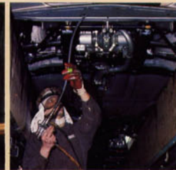
9. HOHLRAUM-VERSIEGELUNG: Unter Druck in die Hohlkörper eingespritztes Wachs schützt Innenwände und Innenräume. Eindringen von Wasser und Spritzwasser in Zwischenräume und Nahtstellen wird verhindert.
