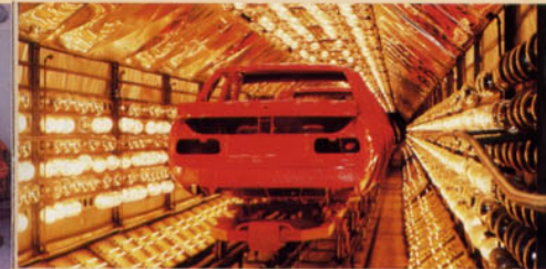
8. FARBLOSE LACKSCHICHT (bei Metallackierung): Verstärkt den Glanz und erhöht den Schutz der Farbschicht gegen Witterungs- und Waschstraßen-Einflüsse.
