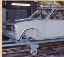
6. GRUNDIERUNG: Diese Schicht enthält Pigmente, die oxydationshemmend wirken. Sie sorgen für erhöhten Korrosions- und Steinschlagschutz und verbessern die Haftung der Lackschicht.
