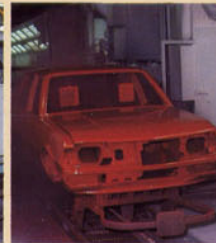
7. LACKIERUNG: Hochwertiger Acryl-Lack wird absolut gleichmäßig aufgetragen, mit 130° C eingebrannt und wärmegehärtet. Aufgrund der schnellen Verdampfung der Lösungsmittel entwickeln sich hohe Schutzeigenschaften.
