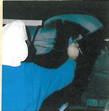
5. STEINSCHLAGSCHUTZ (PVC): Mit ca. 140° eingebrennte PVC-Schicht schützt Karosserieteile, die Steinschlag ausgesetzt sind (vor allem am Unterboden und in den Radkästen).
