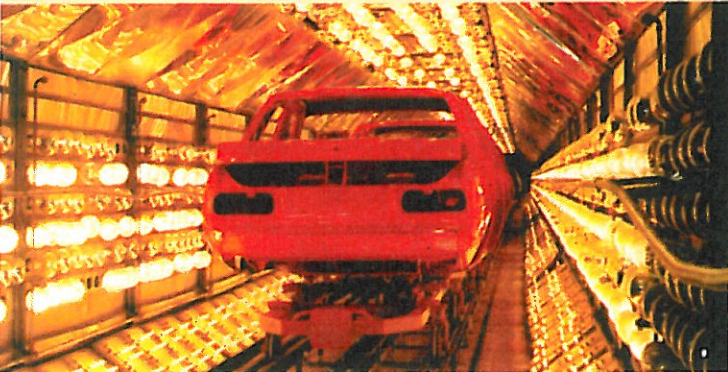
8. FARBLOSE LACKSCHICHT (bei Metallackierung): Verstärkt den Glanz und erhöht den Schutz der Farbschicht gegen Witterungs- und Waschstraßen-Einflüsse.
