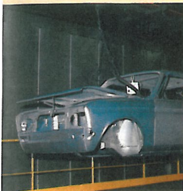
2. PHOSPHATIERUNG: Zink- und Manganphosphatierung der gesamten Karosserie verbessert die Haftung des Harzfilmes im Kataphorese-Tauchbad.
