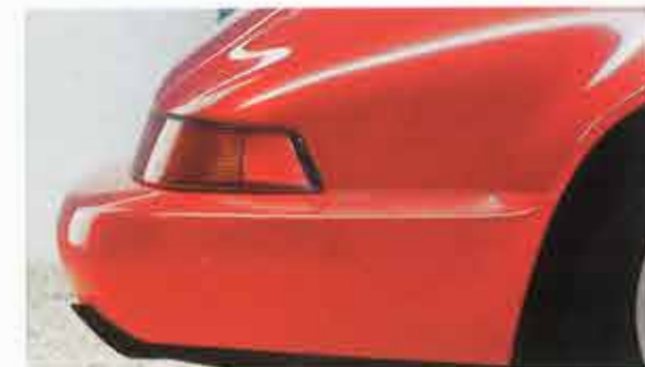
Durch Feinarbeit an der Karosserie haben wir die Aerodynamik verbessert. Die integrierten Front- und Heckstoßfänger überstehen schadlos kleinere Stöße bis 5 km/h.
