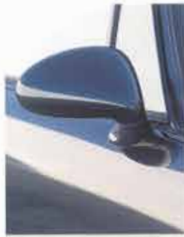
Bessere Aerodynamik auch durch neue Form der Außenspiegel
