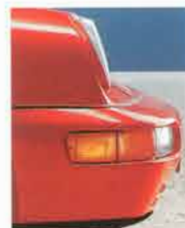
Stoßfänger aus Bexloy schützen gegen Stein schlag
