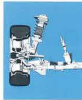
Die Vorderräder werden an Dreieckslenkern und Federbeinen geführt
