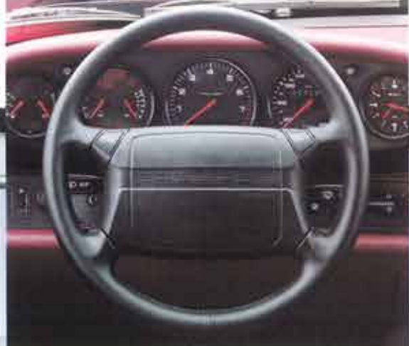
Airbag auf Wunsch für Fahrer und Beifahrer. Beim Unfall füllt sich das Sicherheitshissen in Sekundenbruchteilen und schützt vor Verletzungen
