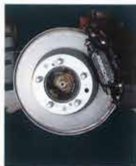
Bei Porsche selbstverständlich: Innenbelüftete Scheibenbremsen hinten
