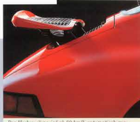
Der Heckspoiler wird ab 80 km/h automatisch ausgefahren. Er vergrößert den Kühlluft eintritt. Gleichzeitig vermindert er Luftwiderstand und Auftriebskräfte
