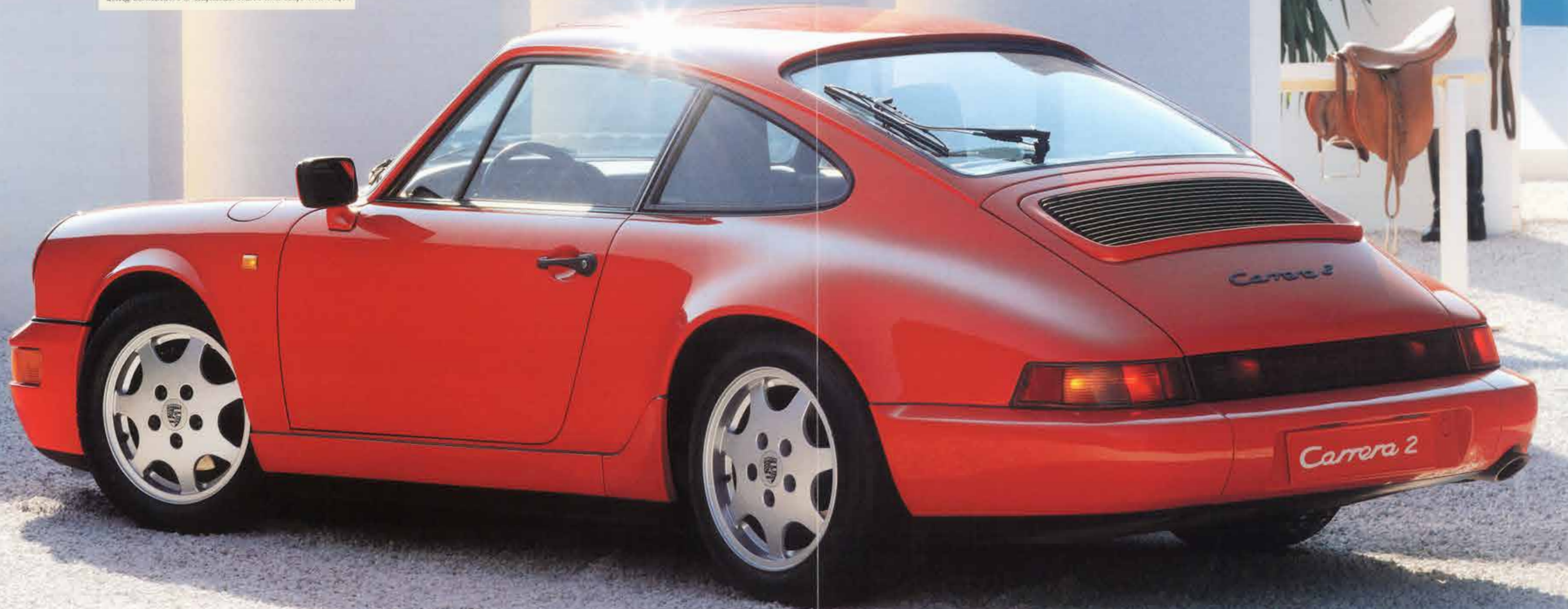
Der Heckspoiler wird ab 80 km/h automatisch ausgefahren. Er vergrößert den Kühlluft eintritt. Gleichzeitig vermindert er Luftwiderstand und Auftriebskräfte
