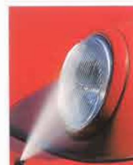
Hochdruckpumpen reinigen die H4-Scheinwerfer von Carrera 2 und 4
