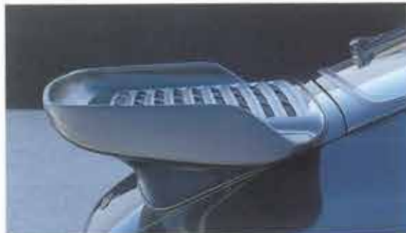
Charakteristische, breite Turbo Heckpartie. In den feststehenden Spoiler ist der Ladeluftkühler integriert
