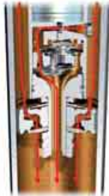
Zugstufe – Arbeitskolben und Bypass, sportlich-komfortable Abstimmung
