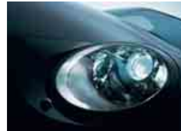
Scheinwerfer mit Bi-Xenon-Technik
