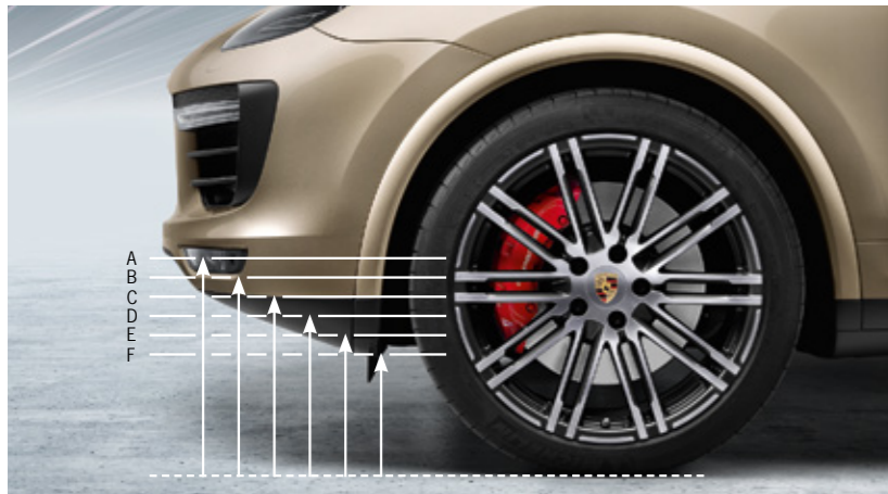
Luftfederung inkl. PASM. Mehr Fahrdynamik, mehr Fahrkomfort (Seite 54) 1)
