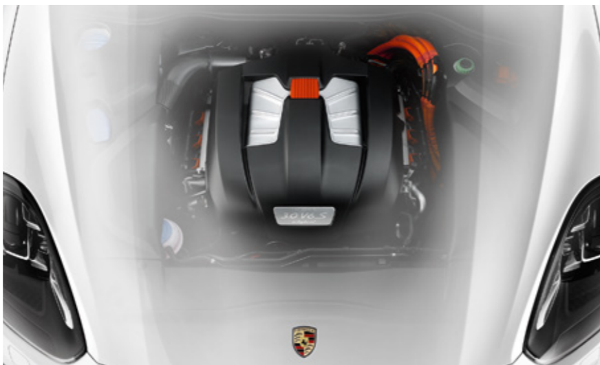
Cayenne S E-Hybrid gesamt: 590 Nm zwischen 1.250 und 4.000 1/min, 306 kW (416 PS) bei 5.500 1/min
