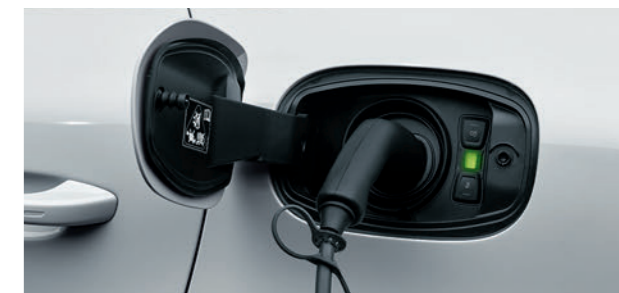
Neuer Ladeanschluss mit Entriegelungstaste
