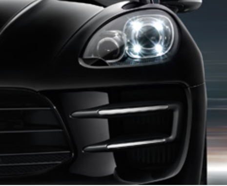
Tagfahrlicht mit Bi-Xenon-Scheinwerfer
