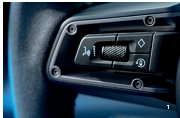
1 Rekuperationstaste am Lenkrad zum Wechseln der Rekuperationsstufen
