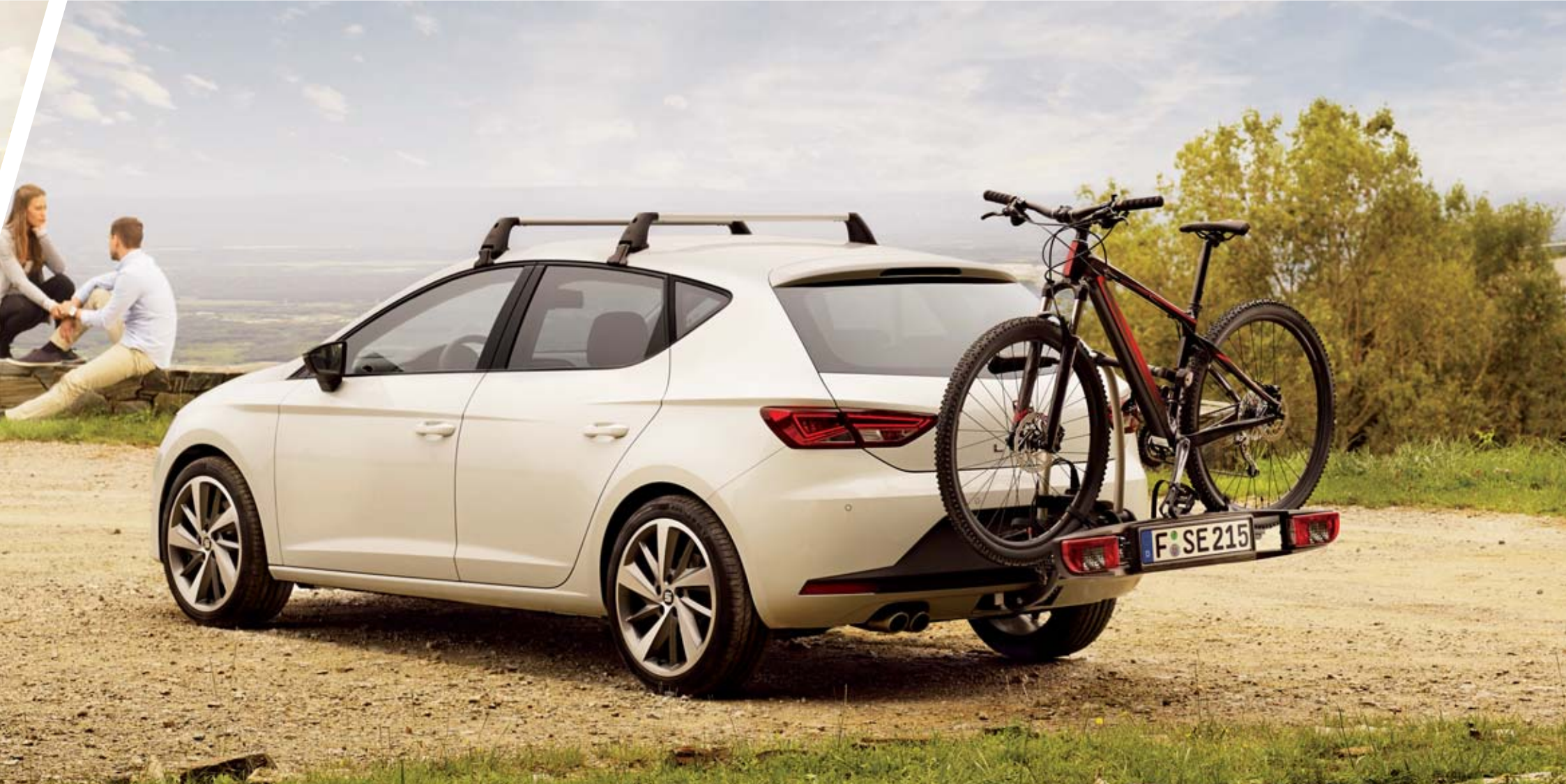
FAHRRADTRÄGER FÜR ANHÄNGEVORRICHTUNG. Klappbarer Fahrradträger zur Montage auf der Anhängervorrichtung. Zum Transport von 2 Fahrrädern.
