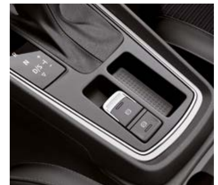
Integrierte elektrische Feststellbremse.
