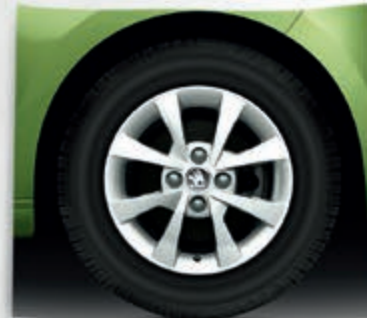
Leichtmetallfelge Apus 5,0J x 14" mit 175/65-R14-Bereifung, Serie im Elegance, optional für Active und Ambition.
