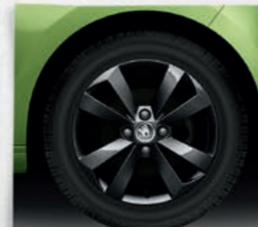
Leichtmetallfelge Auriga 5,5J x 15" mit 185/55-R15-Bereifung, schwarz, optional für Ambition und Elegance.
