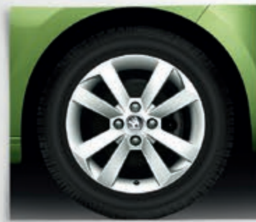
Leichtmetallfelge Auriga 5,5J x 15" mit 185/55-R15-Bereifung, optional für Ambition und Elegance.
