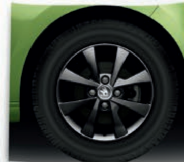
Leichtmetallfelge Apus 5,0J x 14" mit 175/65-R14-Bereifung, schwarz, optional für Active, Ambition und Elegance.
