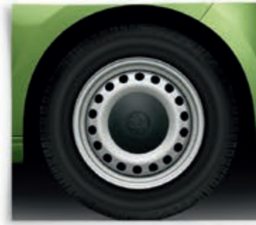
Radzierblende Puck 5,0J x 14" mit 165/70-R14-Bereifung, Serie im Easy.
