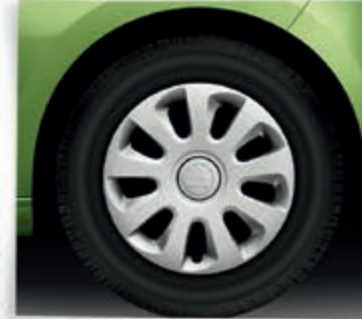
Radzierblende Aries 5,0J x 14" mit 165/70-R14-Bereifung, Serie im Active und Ambition.
