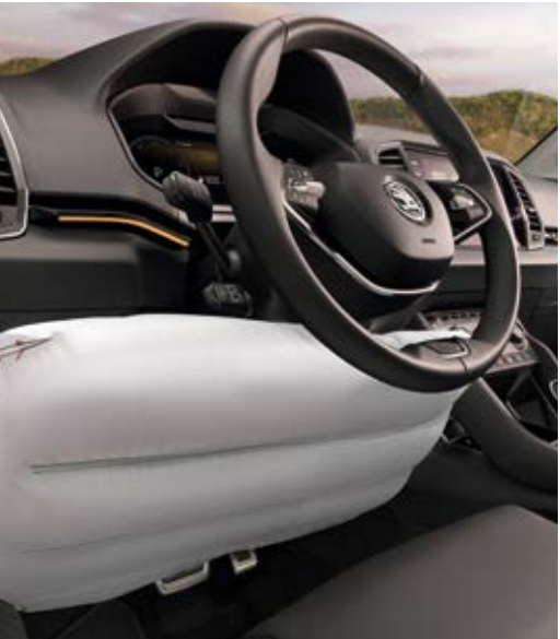
KNIEAIRBAG Dieser Airbag, der sich unter der Lenkradsäule befindet, schützt Knie und Schienbeine des Fahrers.
