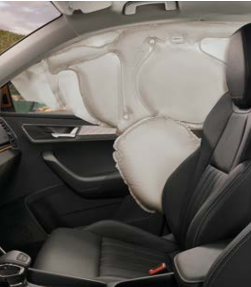
SEITENAIRBAGS VORN UND HINTEN Die Seitenairbags (hier zusammen mit dem aktivierten Kopfairbag abgebildet) schützen bei einem Seitenaufprall Becken und Brustkorb aller Insassen.
