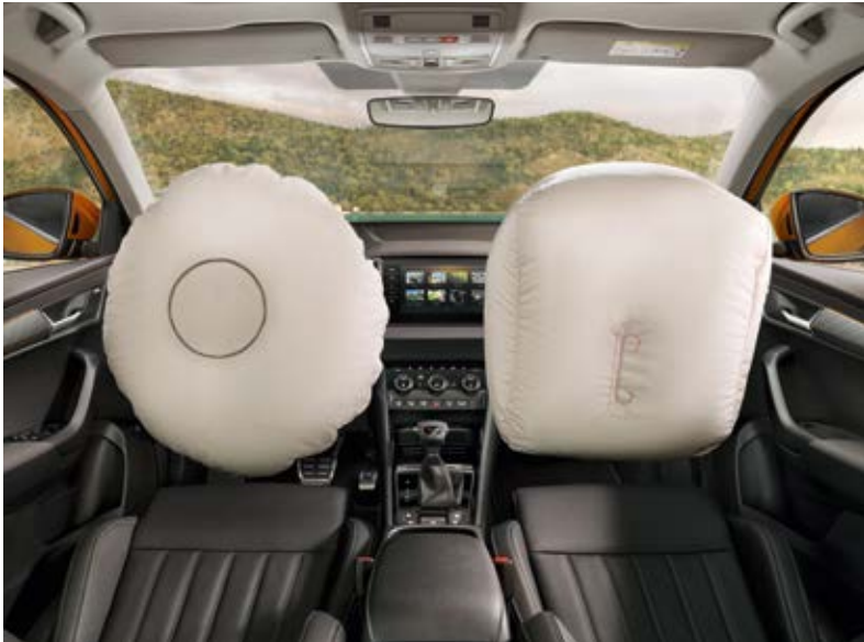
FAHRER- UND BEIFÄHRERAIRBAGS VORN Während der Fahrerairbag im Lenkrad untergebracht ist, befindet sich der Beifahrerairbag in der Armaturentafel. Dieser kann bei Bedarf deaktiviert werden, wenn ein Kindersitz auf dem Beifahrersitz installiert ist.
