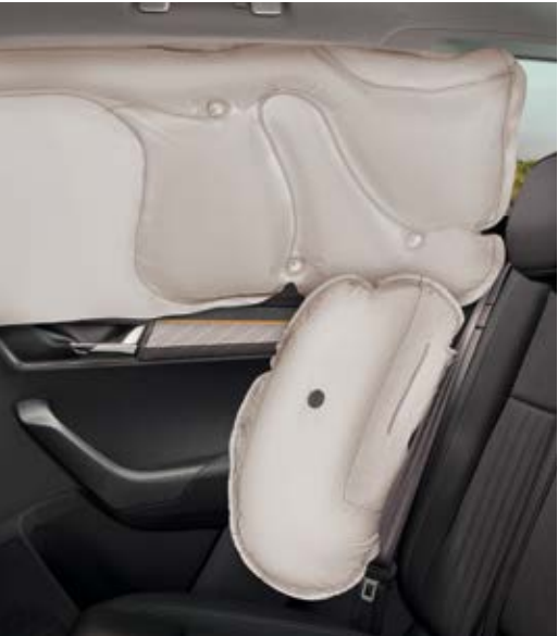
SEITENAIRBAGS VORN UND HINTEN Die Seitenairbags (hier zusammen mit dem aktivierten Kopfairbag abgebildet) schützen bei einem Seitenaufprall Becken und Brustkorb aller Insassen.
