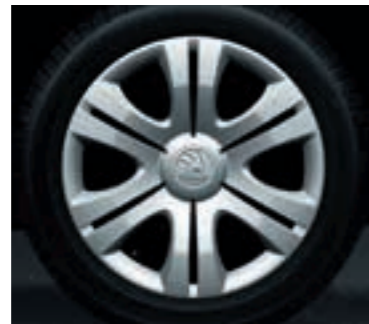
Stahlfelgen mit Radzierblenden Satellite 6,0J x 15" mit 195/55-R15-Bereifung, Serie bei Active und Ambition.
