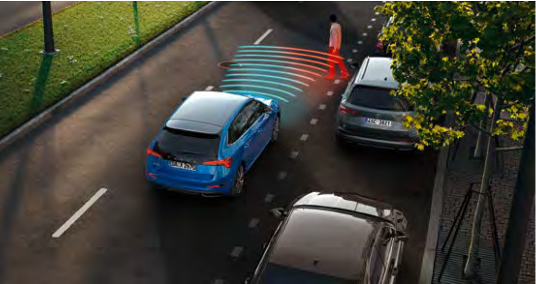
FRONTRADARASSISTENT INKL. CITY-NOTBREMSFUNKTION UND PERSONENERKENNUNG Über einen Radar im Kühlergrill überwacht der serienmäßige Frontradarassistent den Abstand zum vorausfahrenden Fahrzeug und löst bei Gefahr eine Notbremsung aus. Beim SCALA ist der Frontradarassistent zusätzlich mit einem vorausschauenden Fußgängerschutz ausgestattet, der Sie mit einem audiovisuellen Signal und leichtem Bremsen warnt.
