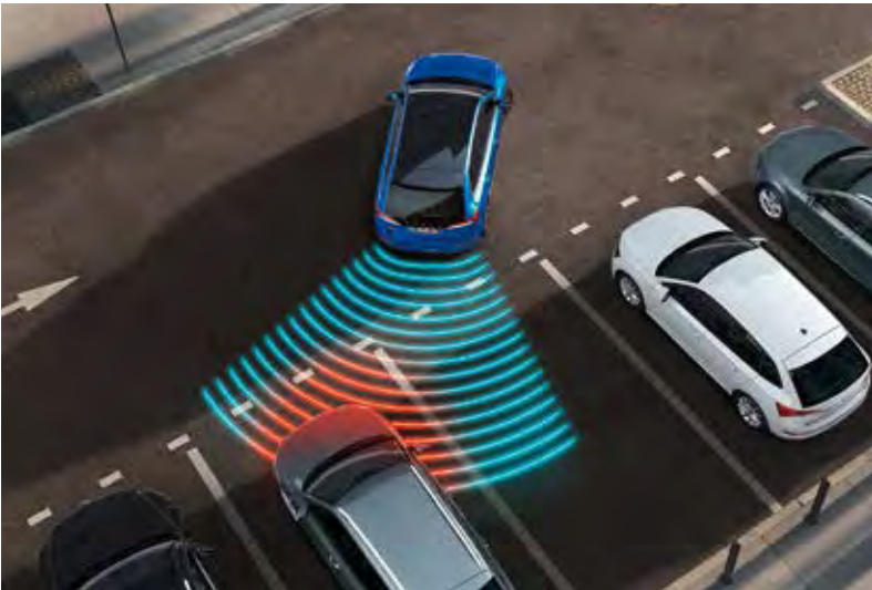
PARKSENSOREN Einparksensoren im vorderen und hinteren Stoßfänger messen den Abstand zu möglichen Hindernissen – und machen so das Einparken kinderleicht.
