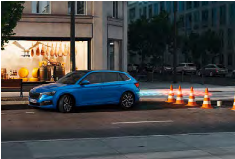
RANGIERBREMSASSISTENT Dieses System bietet Schutz vor Hindernissen in Reichweite des Fahrzeugs (bei Geschwindigkeiten zwischen 1,5 km/h und 10 km/h). Wird ein Hindernis erkannt, löst das System bei Gefahr eine Notbremsung aus.
