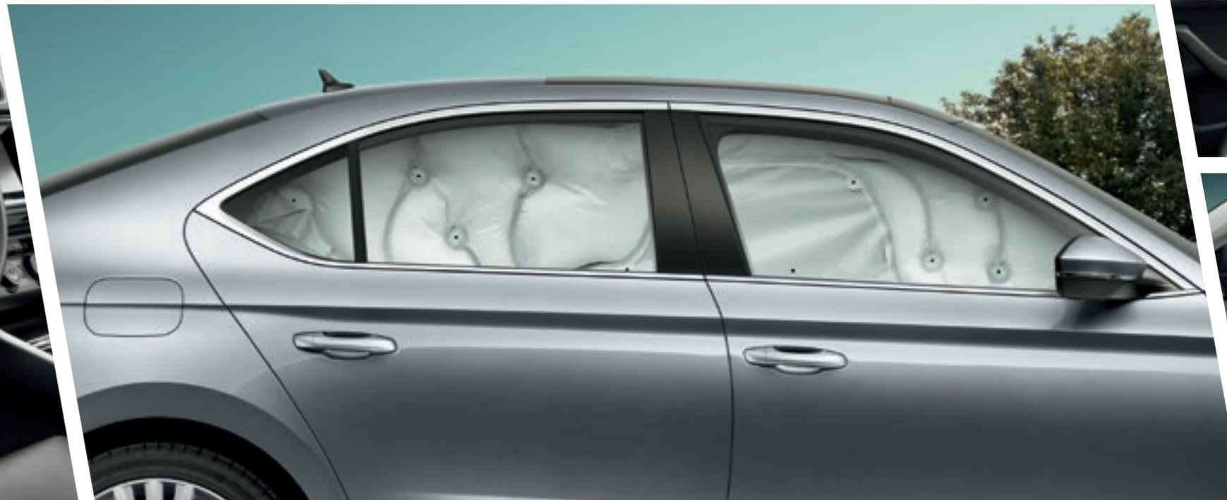
Aktivierte Kopfairbags bilden einen Puffer, der sowohl die vorderen Passagiere als auch die Fahrgäste im Fond vor Kopfverletzungen schützt.
