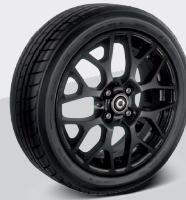
40,6 cm (16\") Leichtmetallräder (R95) im 8-Y-Speichen-Design in schwarz lackiert, mit Bereifung vorn 185/50 R 16, hinten 205/45 R 16¹
