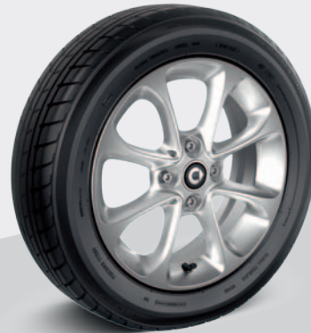
38,1 cm (15\") Leichtmetallräder (R88) im 8-Speichen-Design in silber lackiert, mit Bereifung vorn 165/65 R 15, hinten 185/60 R 15
