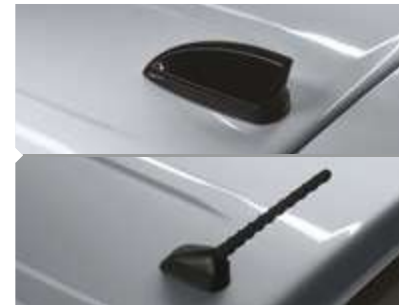
Haifischflossenantenne (oben) und Stabantenne
