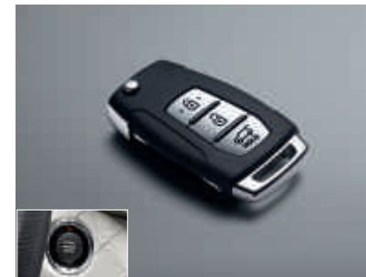
Smart-Key-System mit schlüssellosem Zugang und Start-/Stopp-Knopf
