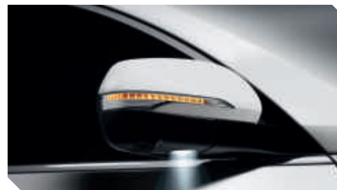
Seitenblinker und Umfeldbeleuchtung im Außenspiegelgehäuse
