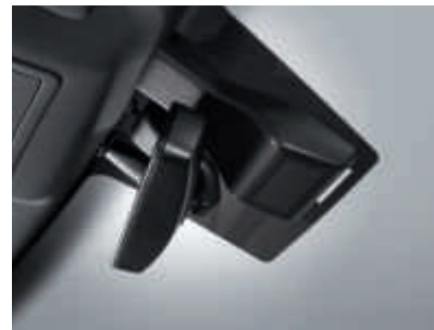
Frontkamera für Fahrerassistenzsysteme und Licht- und Regensensoren
