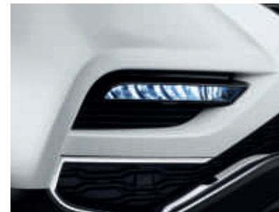
LED-Nebelleuchten mit integriertem Abbiegelicht
