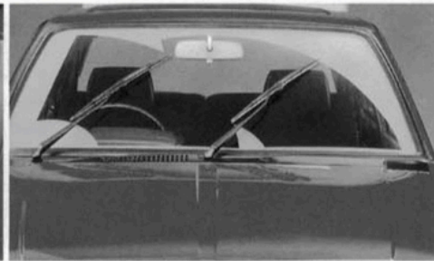
Intervall-Scheibenwischer mit elektrischer Wisch-/Wasch-Anlage und Intervall-Schaltung
