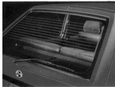
Heizbare Heckscheibe mit Wisch-/Wascheinrichtung
