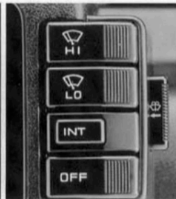
Intervall-Scheibenwischer mit elektrischer Wisch-/Wasch-Anlage und Intervall-Schaltung
